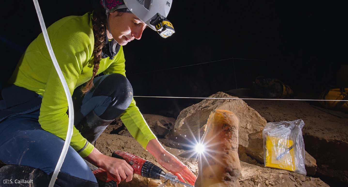
Entnahme eines 8 mm dicken Bohrkerns aus einem Stalagmiten zur Altersdatierung
