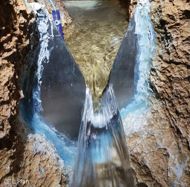
Ein Messwehr mit einem Datensammler (blau) ermöglicht die Aufzeichnung von Wasserparametern (Hochschwab).
